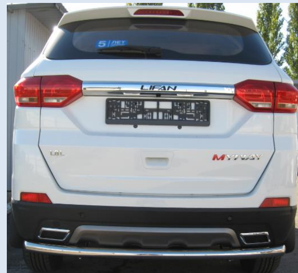
Защита заднего бампера D57 (нержавеющая сталь) Норматив установки 1 н.ч. 1PSR30
