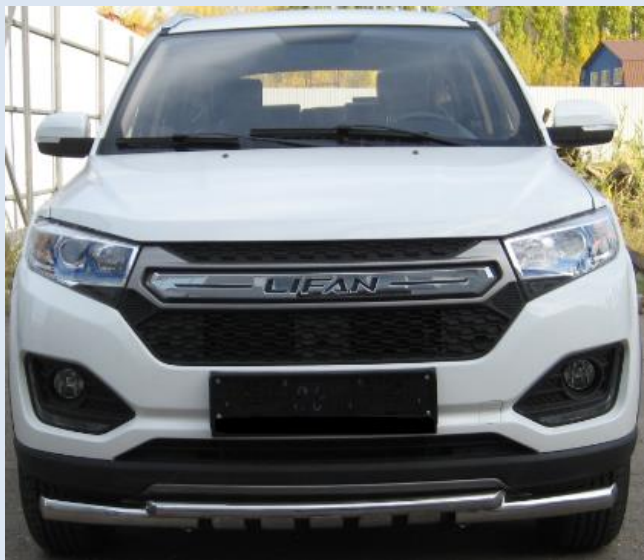
Защита переднего бампера D57+ D42 с декоративными элементами (нержавеющая сталь) Норматив установки 1.5 н.ч. 1PSR21
