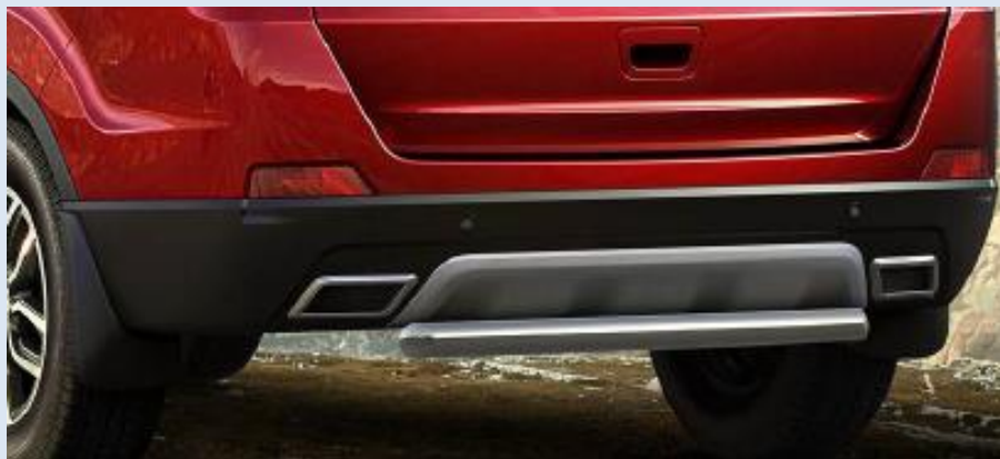
Защита заднего бампера d57 Норматив установки 1.5 н.ч. 1PRR30
