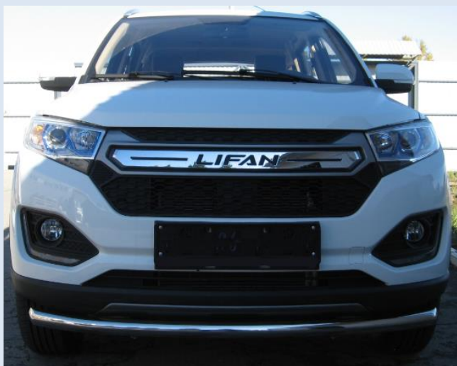
Защита переднего бампера D57 (нержавеющая сталь) Норматив установки 1.5 н.ч. 1PSR22
